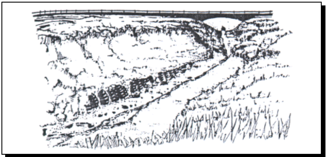
Figura 2.3 - Proteção de canais com pneus - aspecto final
