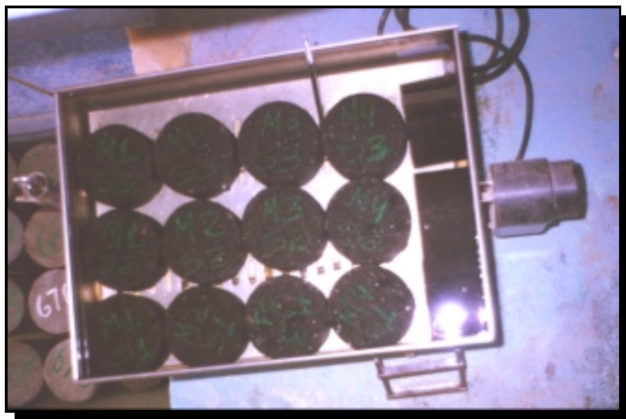
Figura 4.2 - Corpos de prova, prestes a serem submetidos ao ensaio de resistência à tração, estão imersos em água com temperatura de 25° C
