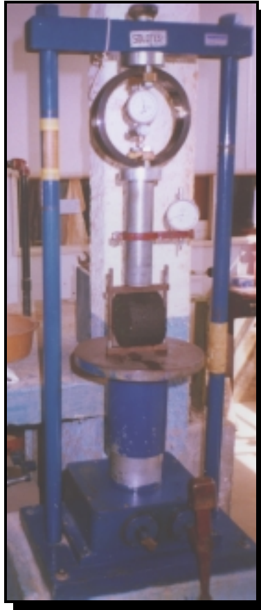
Figura 4.3 - Prensa onde foram realizados os ensaios de resistência à tração
