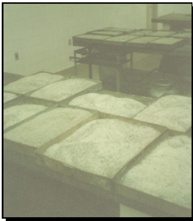
Figura 3.2 - Parte do agregado disposto em bandejas para ser colocado na estufa
