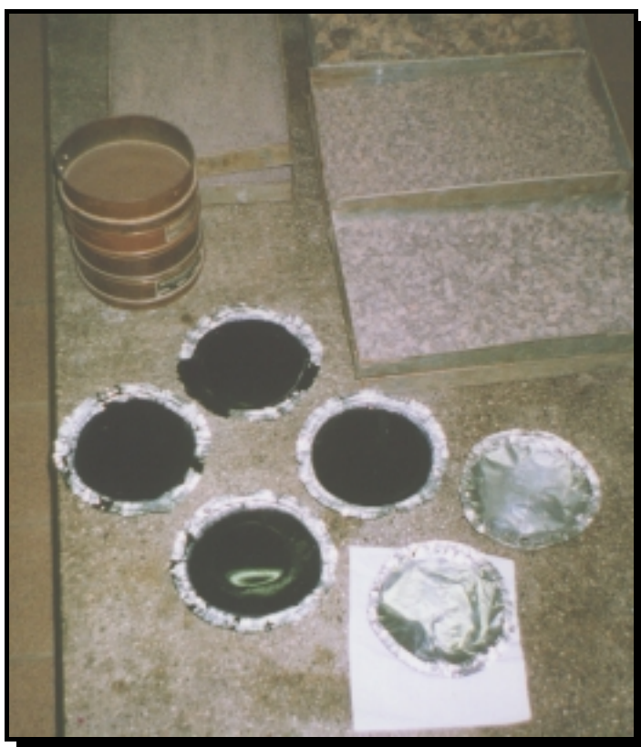
Figura 3.3 - O asfalto foi acondicionado em embalagens fechadas de alumínio.
